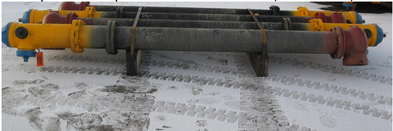
(Ci-haut) Photo montrant une borne de 8'6" de tranchée
